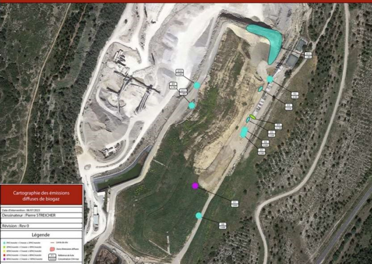
Cartographie des émissions diffuses de biogaz ISDND de Castries
